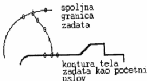
Sl. 1 — Osnovne ideje generiranja proračunskih mreža primenom PDJ
