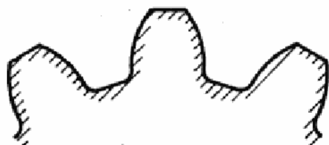
Sl. 19 — Raspored zona ojačanja pri hemijsko-termičkoj obradi (cementacija, nitrocementacija, nitriranje)
