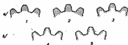
Sl. 16 — Raspored zona ojačanja pri indukcijom kaljenju:
