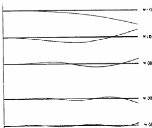
Sl. 3 — Forme vibracija cevi topa
