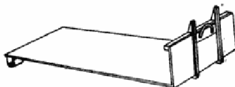
Sl. 2 — Utovarna platforma za prevoz komadnih tereta
