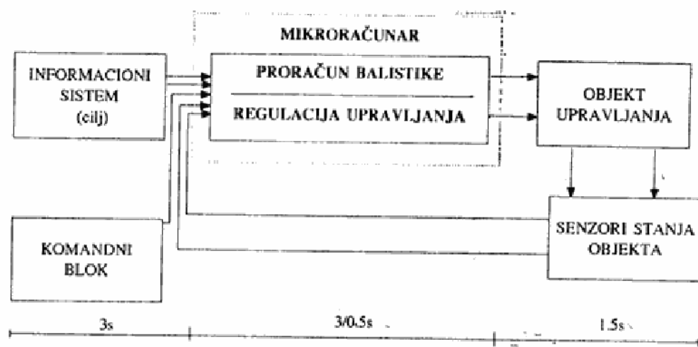
Sl. 3 — Principijelna šema upravljačkog podsistema
