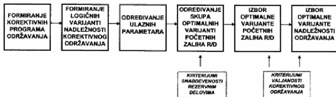
Sl. 1 — Postupak optimizacije korektivnog održavanja kupljenog elektronskog uređaja
