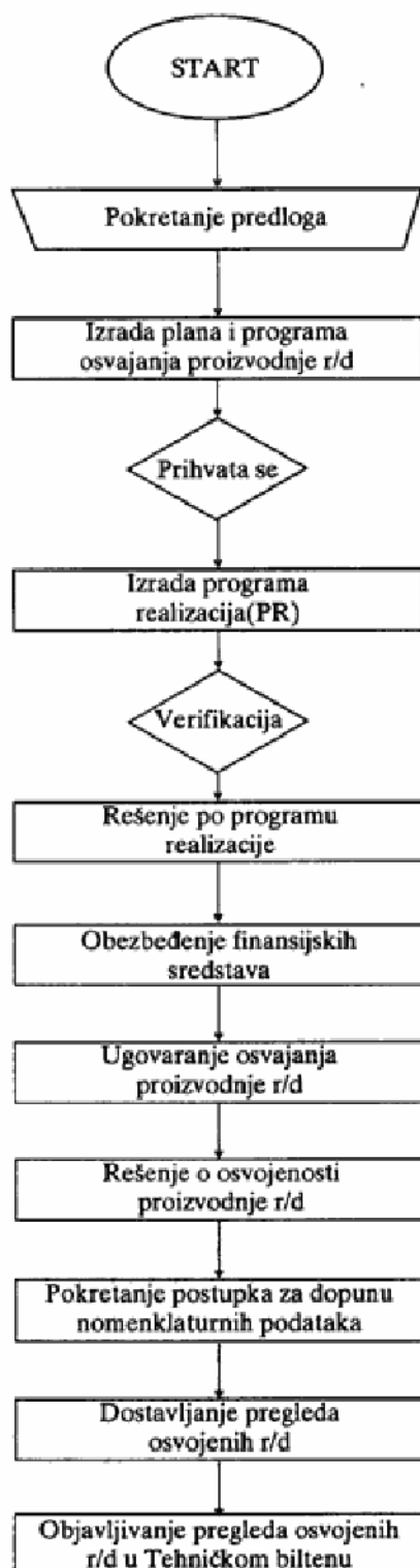
Diagram toka aktivnosti u procesu osvajanja proizvodnje rezervnih delova
