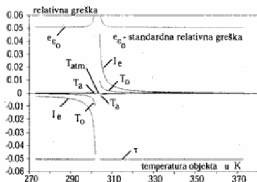
Sl. 2 — Zavisnost greške od temperature površi objekta
