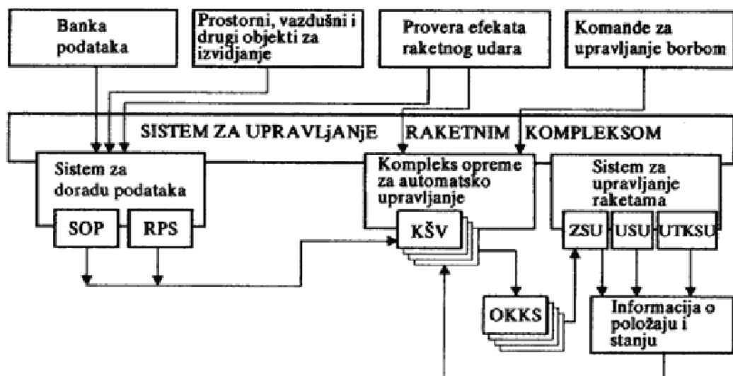
Funkcionalni dijagram sistema za upravljanje raketnim kompleksom: SOP – stanica za obradu podataka, RPS – referentna pripremna stanica, KŠV – komandno-štabno vozilo, ZSU – zemaljski sistem upravljanja, USU – ugrađeni sistem upravljanja (na sredstvu), UTKSU – uporedni sistem upravljanja teren-karta, OKKS – operativno-kontrolni i komunikacijski sistem
