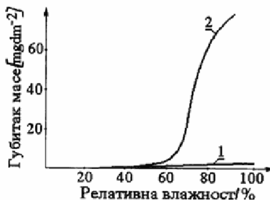
Sl. 2 – Uticaj relativne vlažnosti i zagađenosti vazduha na brzinu korozije gvožđa: 1 – vazduh bez SO 2 , 2 – vazduh sa 0,01% SO 2
