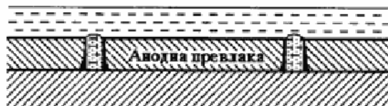
Slika 12 – Šematski prikaz korozije anodne prevlake
