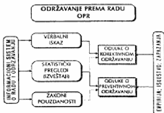
Sl. 2 – Šematski prikaz metode održavanja OCM
