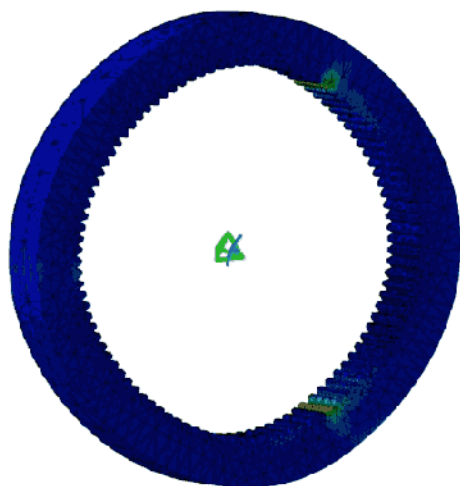
Sl. 11 – Treći oblik oscilovanja venčanika pri f_3 = 2743 \text{ Hz}
