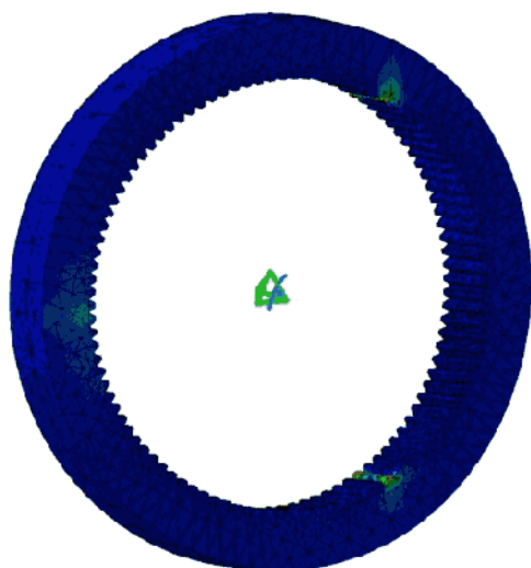
Sl. 10 – Prvi oblik oscilovanja venčanika pri f_1 = 1470 \text{ Hz}
