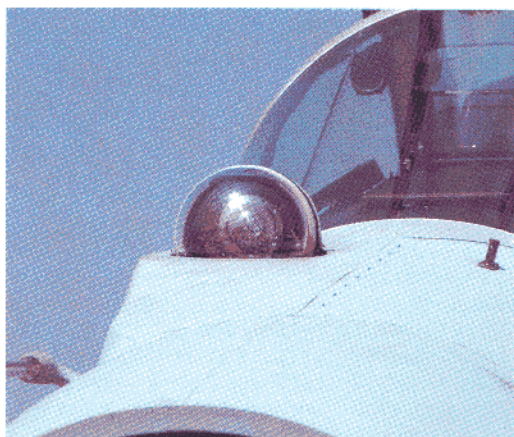
Elektrooptički nišan radara OLS-UEM iznad krova kabine pilota
