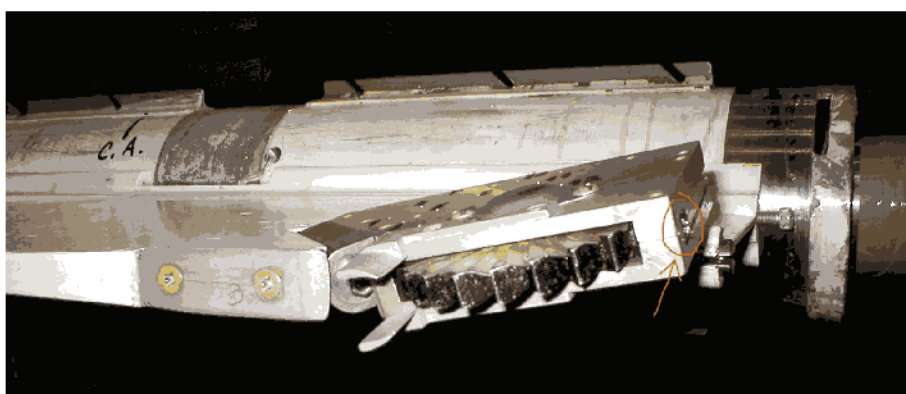
Sl. 6 – Optički davač u blizini rotora rolerona
