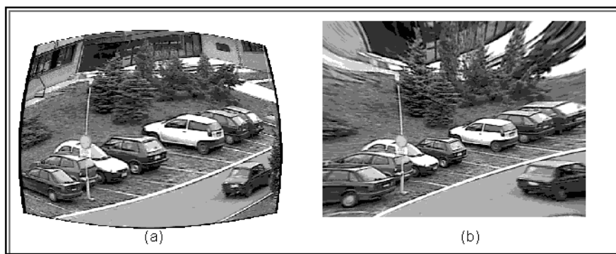
Slika 7 – (a) „barrel“ distorzija; (b) „pincushion“ distorzija slike realne scene
