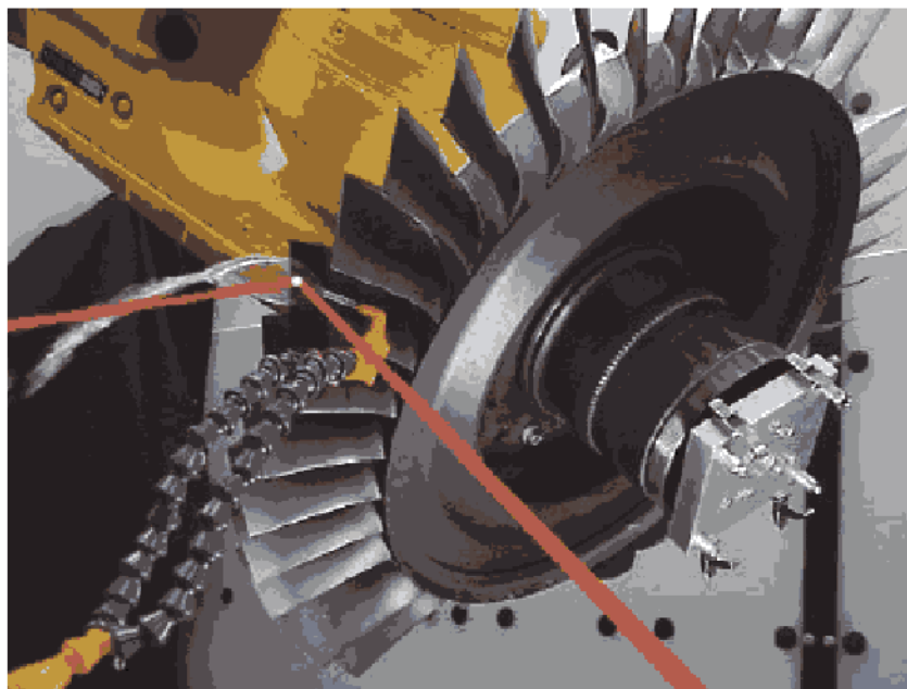
Slika 6 – Bombiranje laserom rotorskih lopatica na motoru F119-PW-100
