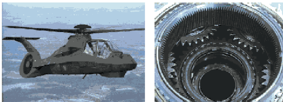
Slika 7 – Primena laserskog bombiranja visokooterećenih prenosnika snage na helikopteru tipa „Comanche“ RAH 66
