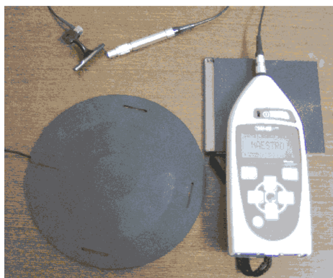
Slika 5 – Uređaj za merenje humanih vibracija - Maestro
