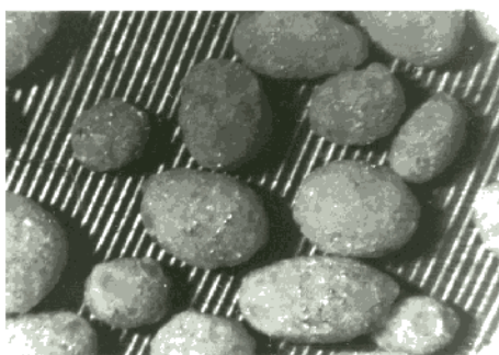
Slika 1 – Izgled granula trokomponentne smeše (RDX, PS, Al),
