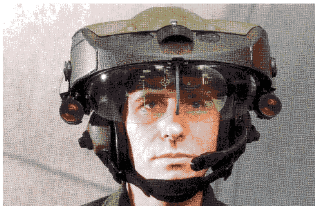
Sistem TopOwl na viziru kacige pilota projektuje sve kritične parametre leta i podatke sa senzora
