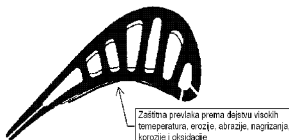
Slika 8 – Presek turbinske lopatice visokog pritiska sa filmom za hlađenje i zaštitnom termičkom prevlakom
