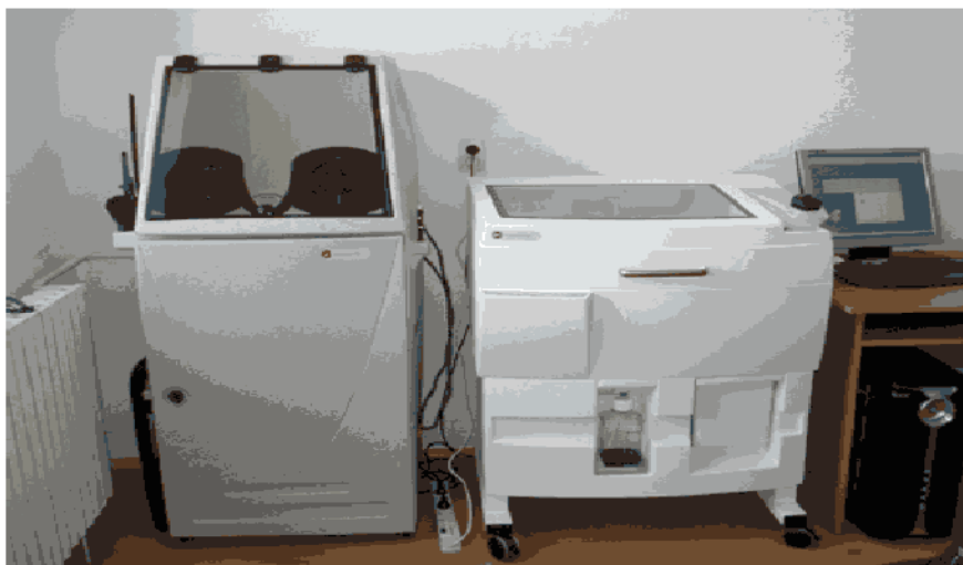
Slika 5 – Sistem za vođenje i štampanje Rapid Prototyping 3D Zcorp 310
