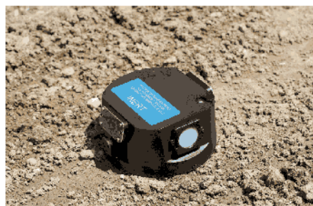
Novi zemaljski senzori za izviđanje, praćenje pokreta protivničke pešadije i motorizovano-oklopnih snaga zasnovani na komercijalnim smart tehnologijama
