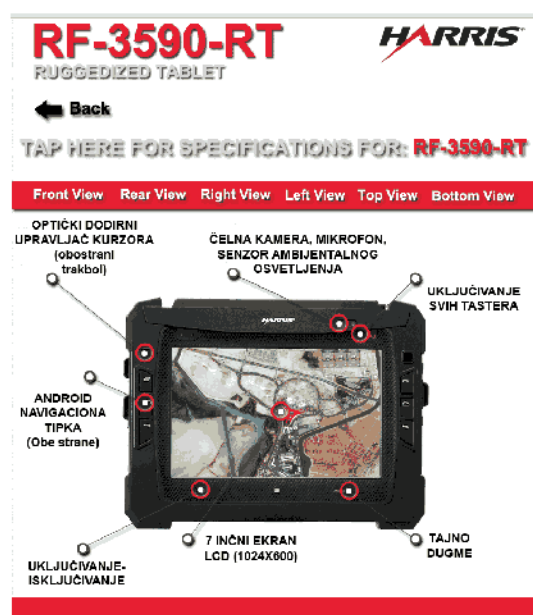
Funkcionalni tasteri tableta RF-3590-RT
