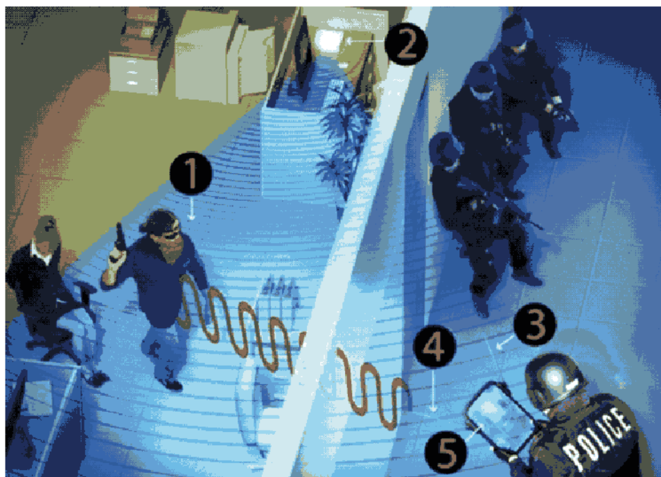
Radarski signal otkriva kretanje s druge strane zida, dok se infracrveni detektor koristi za detekciju toplote ljudskog tela
