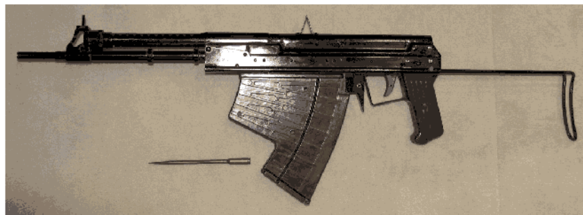
Automatska puška APS 5,45 mm, sa punim okvirom, teška je 3,6 kg
