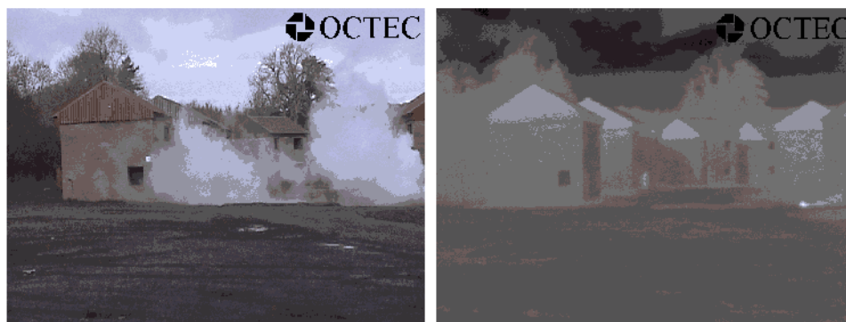
Slika 3 – Slike a) TV i b) termovizijske kamere OCTEC sekvence Figure 3 – Example of a multisensor OCTEC sequence a) visible and b) thermal range
