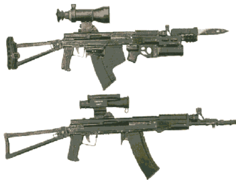
Amfibijska jurišna puška ASM-DT sa okvirom za podvodnu municiju (gore) i klasičnu municiju (dole)
