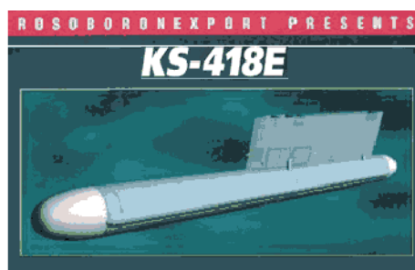
Radio-elektronski sistem KS-418E namenjen za starije modele aviona SU-24
