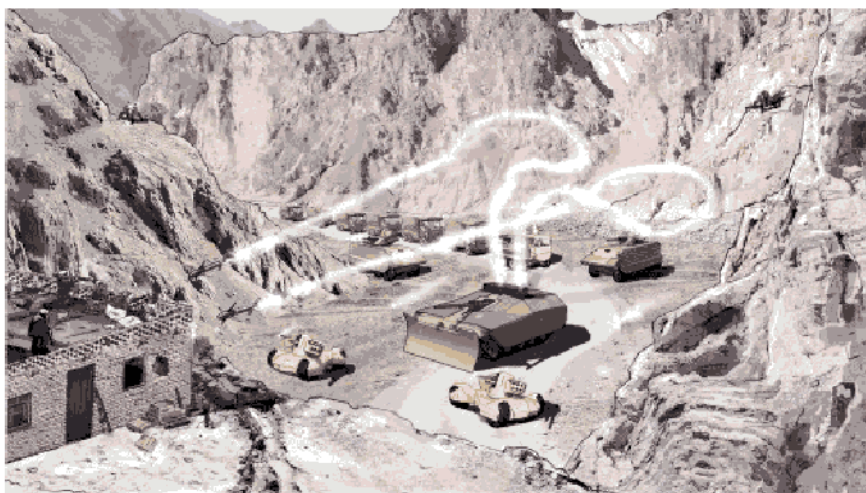
Britanski projekat „buduća zaštićena vozila” sa osnovnim oklopjenim borbenim transporterom naoružanim raketama i topom, u pratnji malih borbenih robota
