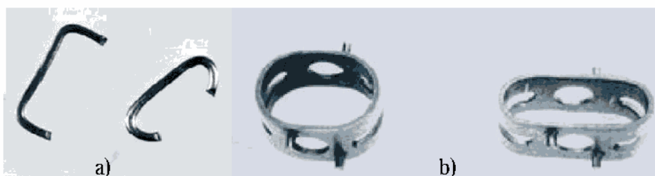
Slika 6 – a) SMA spojnica pre i nakon deformisanja, b) SMA odbojnik pršljenova pre i nakon deformisanja
